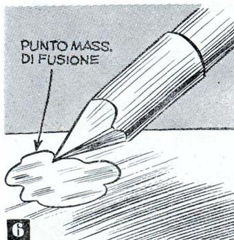
**6** Quando invece il saldatore è scaldato alla giusta temperatura, lo stagno scorre bene, senza accumularsi.
