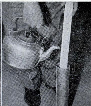
Un recipiente cilindrico può essere utilizzato per plasticizzare delle corte strisce.
