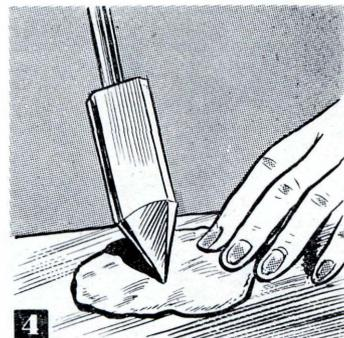
**4** Infine strofinare e girare la punta del saldatoio contro lo straccio umido, per distribuire uniformemente lo stagno. Se necessario, riscaldare di nuovo.
